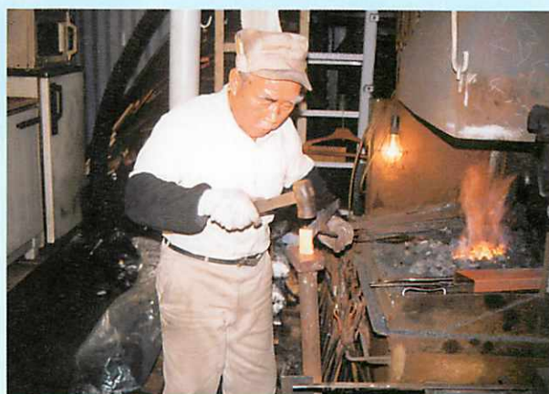
船釘鍛冶、飯島秀雄さん。アカめた鉄をナラシにあててげんのうでたたき、くぎの頭の形を整えていきます。
