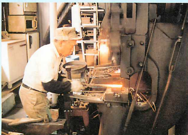
自分の腕よりも長い船釘の先端をベルトハンマーで延ばしています。この船釘は大阪市で復元された弁財船「浪華丸」に使われました。
