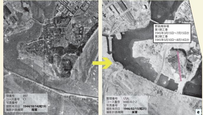
〈野島掩体壕と追浜飛行場〉写真中央の島が野島、下部には追浜の飛行場が見える。左写真は1944年10月14日に、右写真は1946年2月15日に撮影されたものである。右写真では野島から追浜へ、水路を埋め立てて道が造成されているのが確認できる。幅の広い道の下には野島の掩体壕があり、格納された飛行機を追浜の飛行場へ移動させるための道と想定される。
